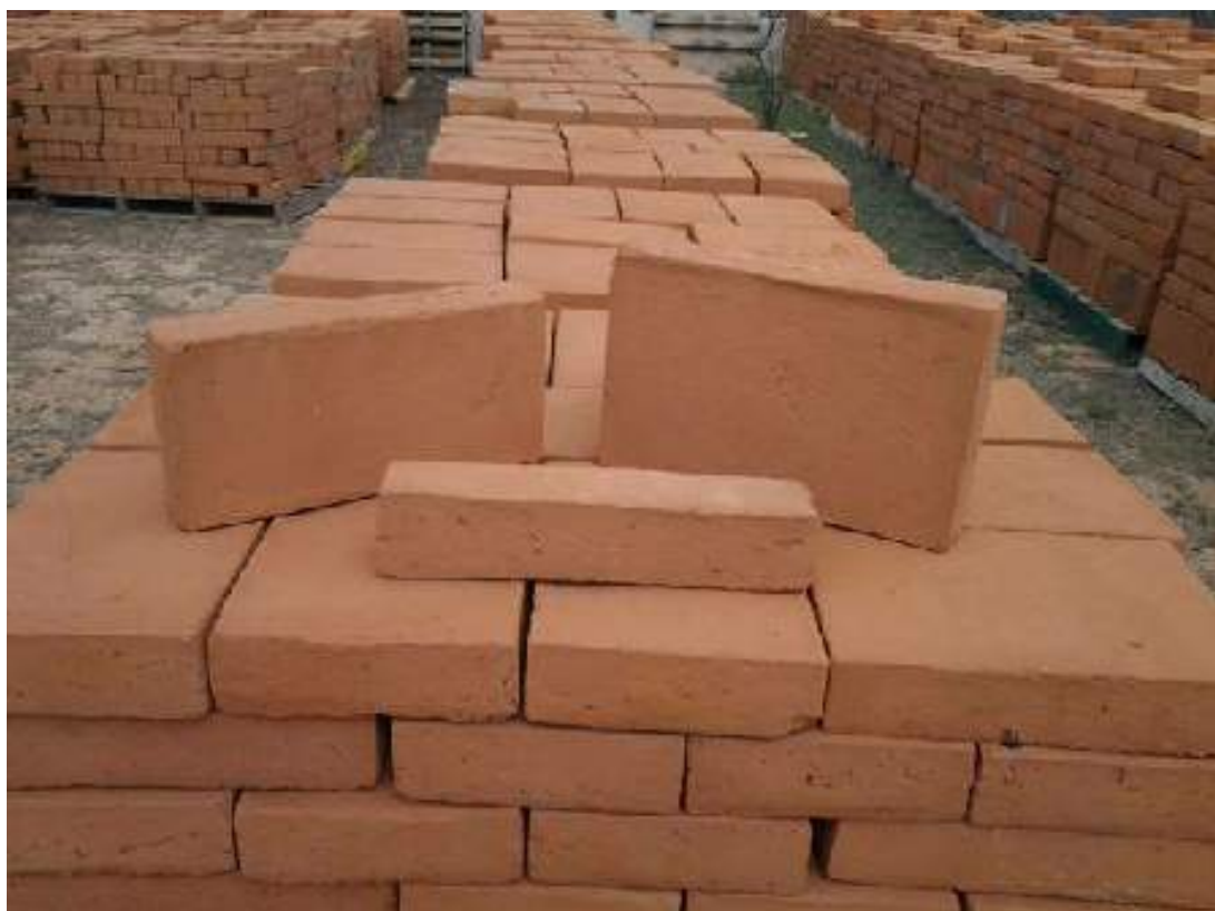
FIGURA 14 - Tijolos da foto anterior já queimados, prontos para serem recepcionados pelos canteiros de obras (Foto: http://www.sasabeadobe.com/making-adobe-bricks.html ).
