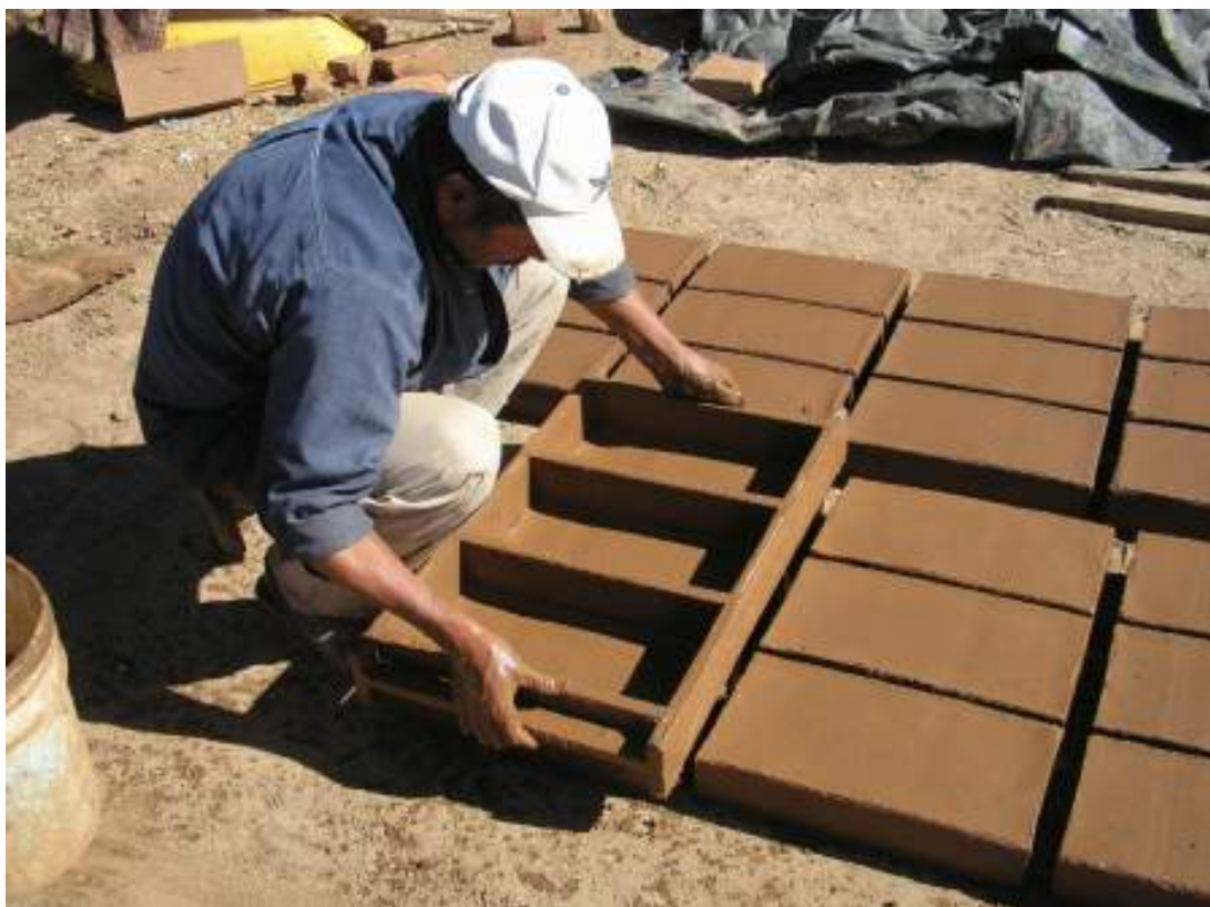
FIGURA 13 - Retirada de tijolos de argila do molde por artesão mexicano. Notar a similitude com os processos que ocorrem no Brasil (Foto: http://www.sasabeadobe.com/making-adobe-bricks.html ).
