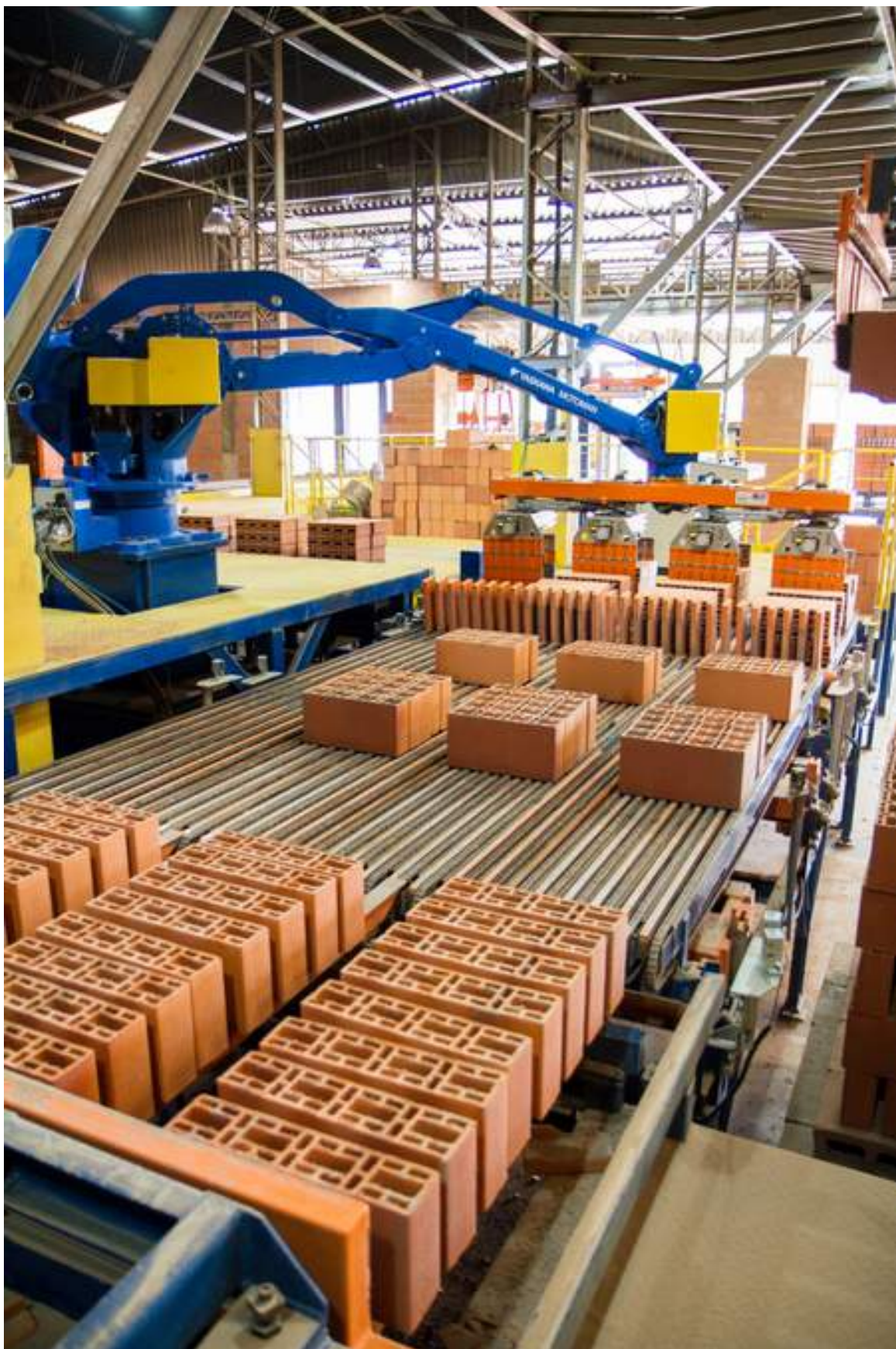
FIGURA 18 - Linha de produção automatizada de blocos cerâmicos, altamente produtiva e tecnificada, colocando no mercado um produto de alta qualidade, padronizado e eficiente (Foto: Cerâmica City, Polo Cerâmico de Tatuí, 2016).
