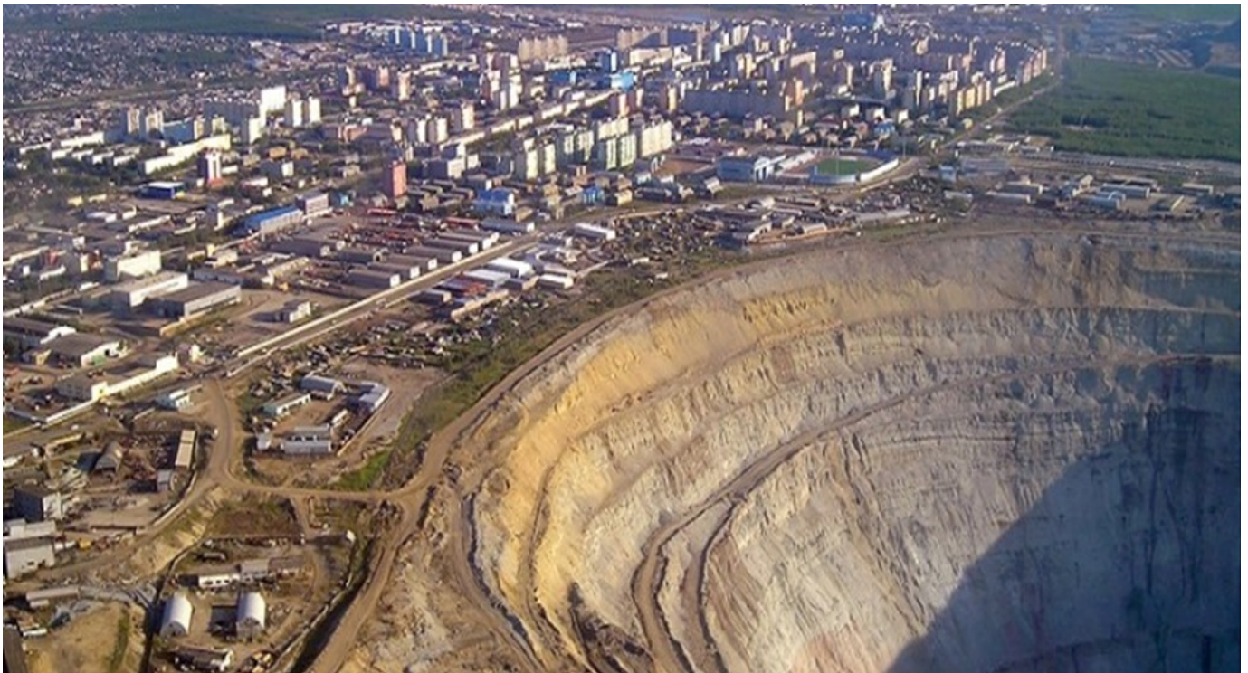
FIGURA 2 - A Mina de diamantes a céu aberto de Mirny, localizada na Yakútia (Federação Russa). Com 525 metros de profundidade e 1200 de diâmetro, as atividades da mina cessaram em 2011. As proporções gigantescas desta cratera falam por si mesmas quanto à intensidade do revolvimento de materiais. Notar, à esquerda da foto, os edifícios da cidade em contraste com o contorno da mina. Contudo, esta cratera é tão só uma dentre milhares existentes em todo o mundo, superada pela Mina de Bingham (Estados Unidos), mina de cobre que possui 970 metros de profundidade e 4.000 de diâmetro (Foto: Pinterest, < https://br.pinterest.com/ >. Acesso: 20-03-2018).
