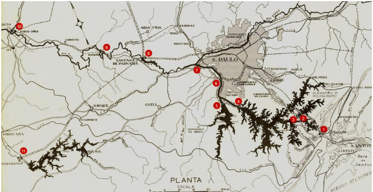
FIGURA 11 - Planta geral do aproveitamento hidrelétrico nas imediações de São Paulo, destacando os objetos hidrotécnicos do Sistema Light no período 1920-1930. Neste mapa, os números correspondem 1: Usina de Cubatão; 2: Canal de Ligação; 3: Barragem reguladora ( summit ); 4: Usina de Recalque de Pedreira; 5: Barragem de Guarapiranga; 6: Usina de Recalque de Traição; 7: Estrutura do Retiro; 8: Usina de Parnaíba; 9: Usina de Rasgão; 10: Usina de porto Góes; 11: Usina de Ituparanga (Fonte: História e Energia, nº. 2, Outubro de 1986, página 12).
